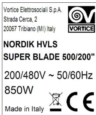
Fig. 1 - ejemplo placa de datos para SUPER BLADE 500/200"
